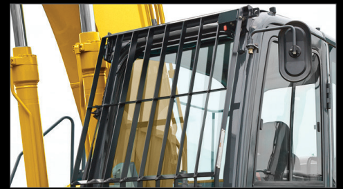
Optional front-guard (bar or mesh)
